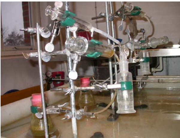
Foto: Forsøgsopstilling som efterligner koens vom. To fodermidler gærer og producerer metan og CO 2 .
